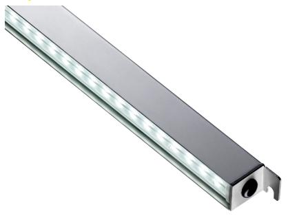
Der Universal-Lichteinsatz aus V4A-Edelstahl mit einer asymmetrischen Lichtverteilung ermöglicht eine hocheffiziente Ausleuchtung von Verkehrsbereichen. Das vollständig vergossene LED-Lichtelement lässt sich nahezu unsichtbar in den Handlauf integrieren. Die LH Variante wird direkt an Netzspannung angeschlossen und ist kompatibel zu den Standard-Dimmern.
