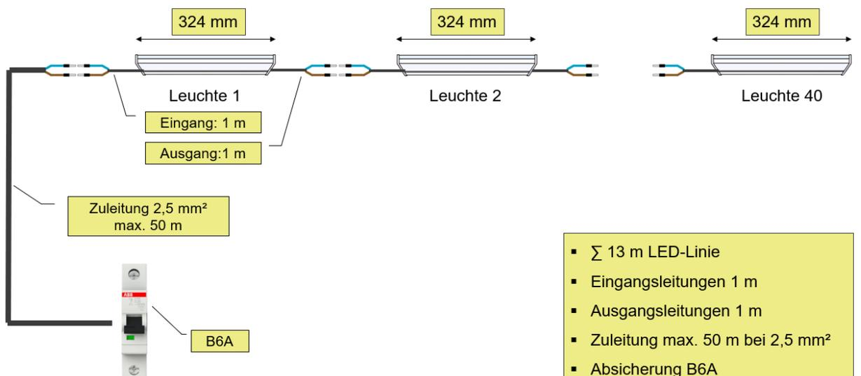
c. Verkettung von 1m-Leuchten: typischer Anwendungsfall bei Handläufen und Bodenlinien
