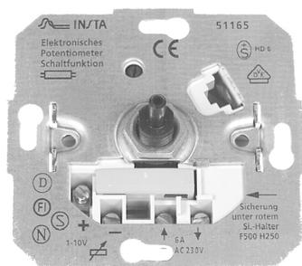
Für alle Netzteile mit 1-10V Schnittstelle zur einfachen Lichtregelung. Wenn die Steuereingänge aller EVG einer umfangreichen Beleuchtungsanlage miteinander verschaltet und über das Potentiometer betrieben werden, kann die gesamte Anlage von zentraler Stelle aus geschaltet und gedimmt werden.
